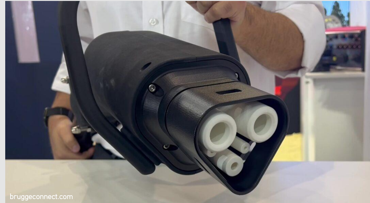
MCS-stekker: standaard voor laden van vermogens tot 3,75 MW
